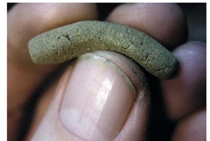
**Bei lehmigem Boden ist der Sandanteil bei der Fingerprobe noch spürbar. Die Bodenmasse lässt sich kneten, ist aber in ihrer Konsistenz noch leicht brüchig.**
